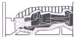
11. Vierta el material de soporte sobre el original dentro de la caja, hasta que el mismo esté completamente cubierto. Mantenga el molde de ésta forma hasta que el material esté completamente endurecido.
