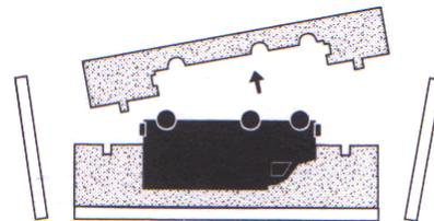
13.Para concluir la preparación del molde, haga dos o más agujeros en la pared superior del mismo. El material de fundición será vertido en el molde a través de los agujeros y el aire saldrá a través del (los) otro (s).
