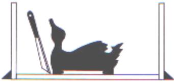
3. Coloque una tira de masa de plastilina en la base del original. Presione el original firmemente sobre la superficie de la caja de moldeo. Retire todo exceso de masa. Marque la posición del original en la base de la caja.
