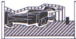
5. Desparrame el material de soporte sobre el original dentro de la caja hasta que el mismo esté totalmente cubierto. Espere hasta que el material esté endurecido.
