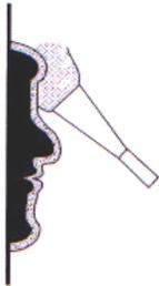
5.Deje curar por 24 hs a temperatura ambiente. Coloque un soporte en el molde de película usando un contramolde de yeso o poliuretano expandido.
