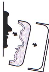
7.Retire la camada de caucho de la superficie del original.
