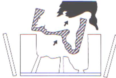
7. Coloque la matriz y la caja de moldeo nuevamente en la posición sobre el original. Vierta lentamente el caucho de siliconas a través del agujero de llenado de la matriz. Continúe vertiendo hasta que el caucho suba a través de las salidas de aire.
