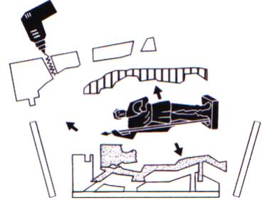
13. Coloque la matriz y la caja nuevamente en su posición inicial sobre el original. Prepare el caucho de siliconas y viértalo lentamente a través del agujero de alimentación. Continúe vertiendo hasta que el caucho salga por los agujeros de salida de aire.
