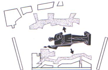
16. Para concluir la preparación del molde, haga 2 o más agujeros en la pared superior del mismo. El material de fundición será vertido en el molde a través de uno de los agujeros y el aire saldrá a través del (los) otro (s).
