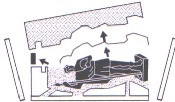
10. Arme nuevamente la caja y aplique un desmoldante en su interior. Cubra la mitad visible del original con una camada de 3mm de plastilina.
